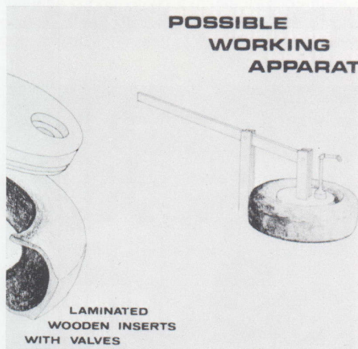
Realisiert: Bewässerungspumpen aus alten Autoreifen. Design: R. Toering.
