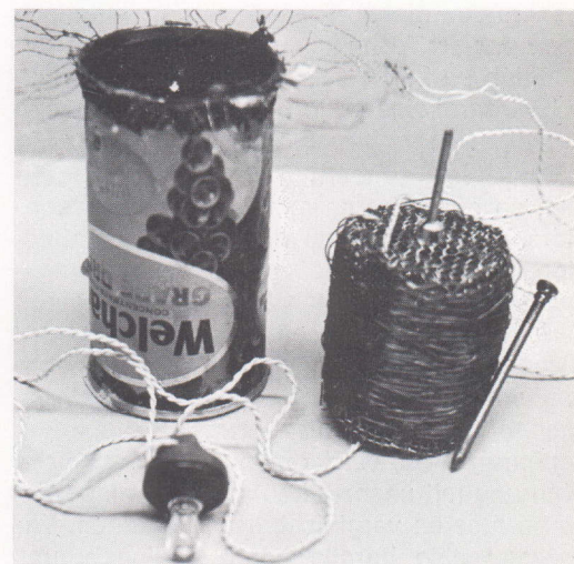
Radio für die Dritte Welt: Dose – Kraftquelle: Paraffin und Docht – für 9 Cents.
